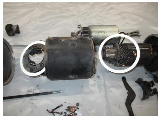
スターターリレーの内部接点の劣化、溶着痕
