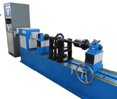
専用のバランステスターにて全数検査
