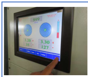
専用のバランステスターにて全数検査
