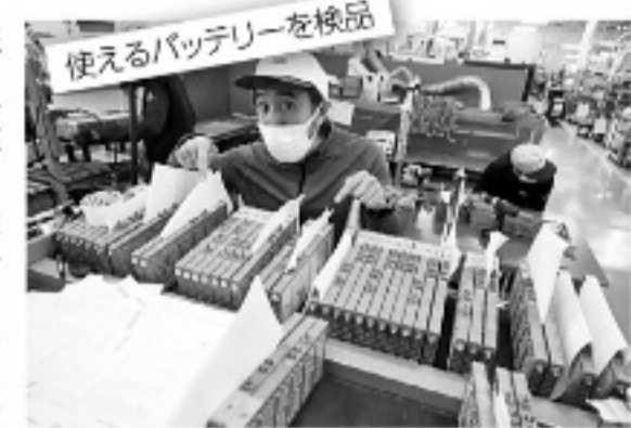
▲これがハイブリッドバッテリーの中身。電池本体の電力を測定して使える物と使えない物を分別
