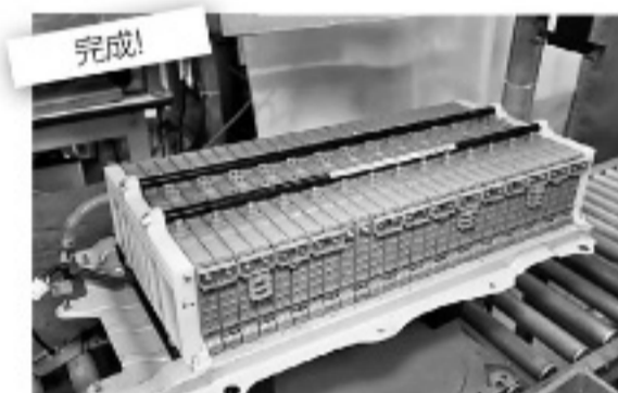
▲これがハイブリッドバッテリーの完成形。小さい電池を組み合わせると一つのバッテリーにする
