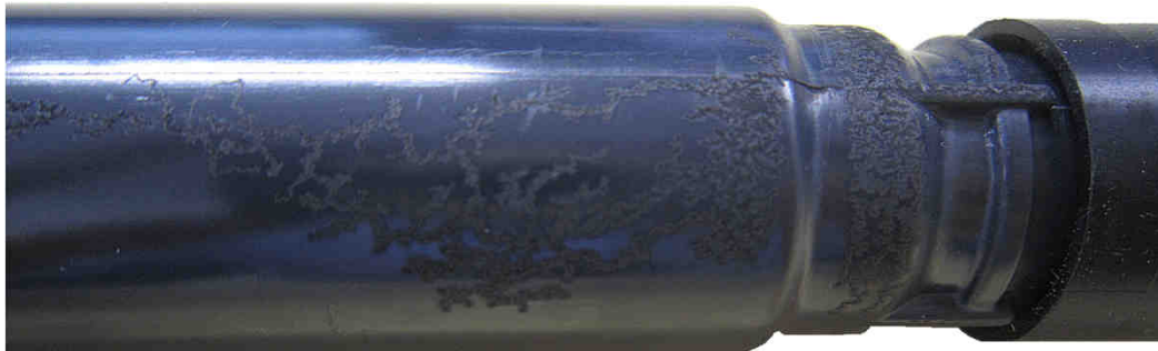
消耗したプラグによるリーク事例
